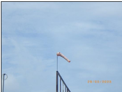
รูปที่ 2-23 อุปกรณ์ตรวจสอบทิศทางลม (Wind sock)
