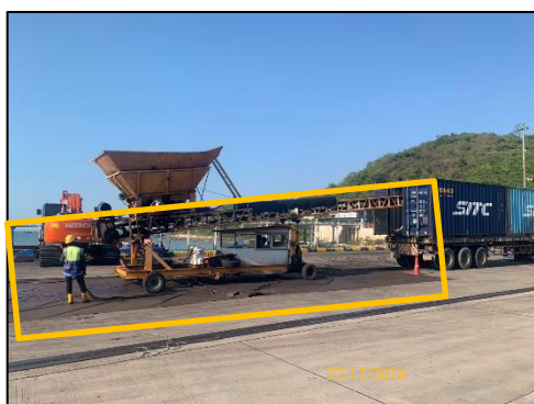
รูปที่ 2-18 การปูรองพื้นด้วยผ้าใบเพื่อเก็บรวบรวมสินค้าที่ร่วงหล่นจากสายพานลำเลียง
